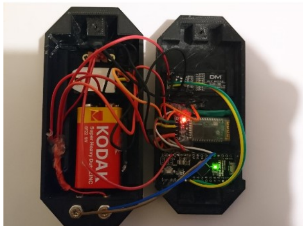
Рис 7 Загальний вигляд монтажу деталей у виготовлений корпус
