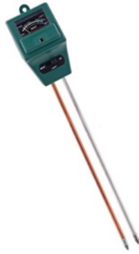
Рис. 2 Загальний вигляд базового аналізатора ґрунту 3в1
