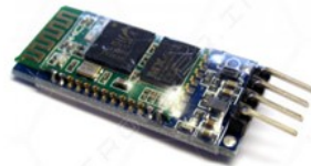
Рис.4. Bluetooth модуль HC - 06
