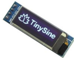
Рис 6. Дисплей OLED дисплей 0.91" I2C 128x32 (чорно-білий)
