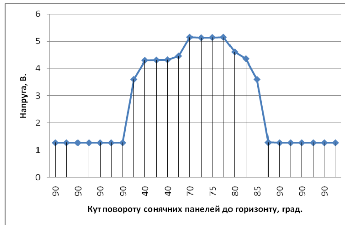
Рис. 12. Залежність напруги, що генерується сонячними панелями, від кута повороту сонячних панелей до горизонту при динамічному слідкуванні системи керування
