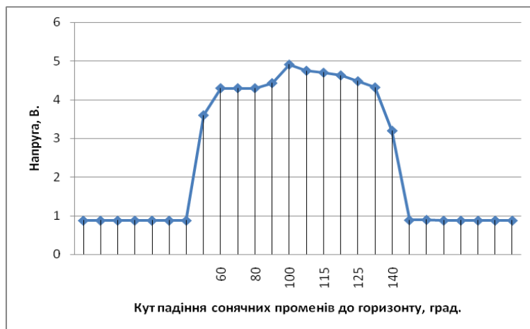
Рис. 11. Залежність напруги, що генерується сонячними панелями, від кута падіння сонячних променів при встановленні її статично під кутом 45^\circ до горизонту на південь
