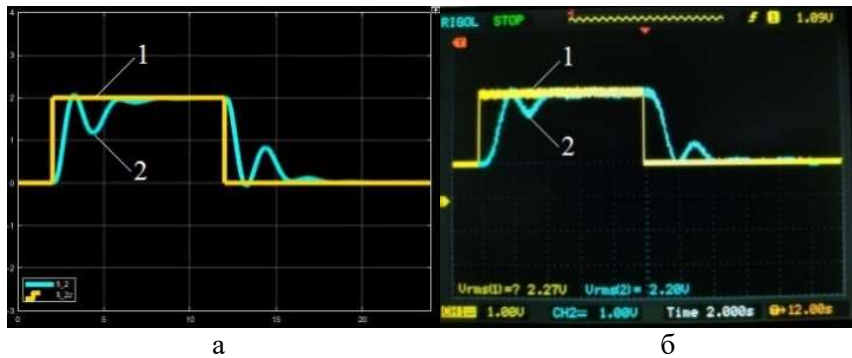
Рис. 6. Графіки сигналу положення другої маси \varphi_2 відносно завдання \varphi_2 ; а - математичної моделі, б - фізичної моделі, де 1 - завдання по положенню, 2 - положення другої маси
