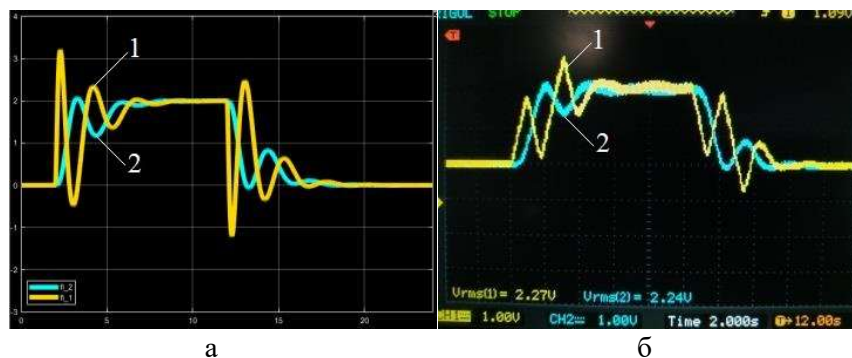
Рис. 7. Графіки перехідних процесів положення першої \varphi_1 та другої \varphi_2 мас: а - математичної моделі, б - фізичної моделі, де 1 - положення першої маси, 2 - положення другої маси
