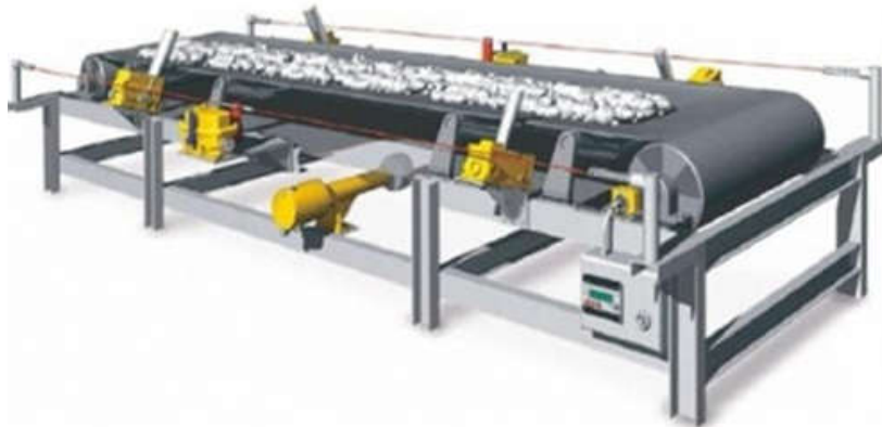
Рис. 1. Зовнішній вигляд стрічкового конвеєру в шахті [1]
