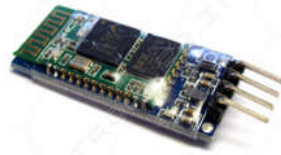
Рис.4. Bluetooth модуль HC - 06
