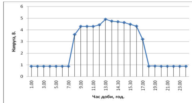
Рис. 9. Залежність напруги, що генерується сонячними панелями, від часу доби при встановленні її статично під кутом 45^\circ до горизонту на південь
