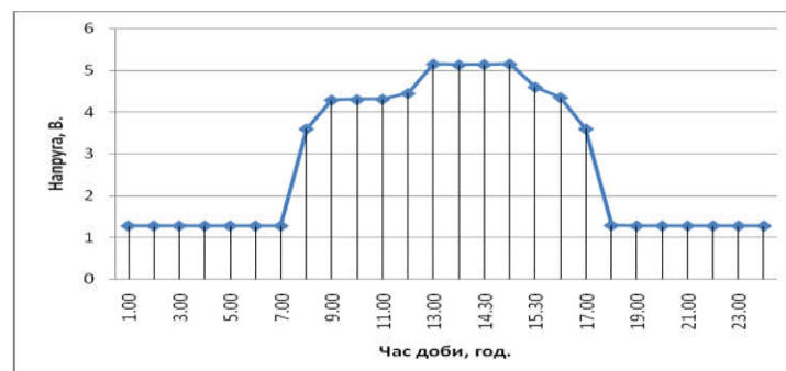
Рис. 10. Залежність напруги, що генерується сонячними панелями, від часу доби при динамічному слідуванні системи керування
