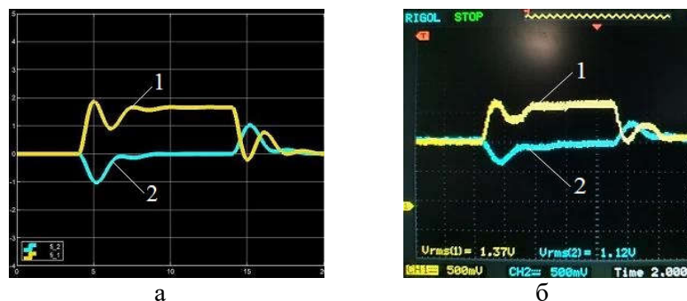
Рис. 8. Графіки перехідних процесів положення першої \varphi_1 та другої \varphi_2 мас при прикладенні M_c : а - математичної моделі, б - фізичної моделі, де 1 - положення першої маси, 2 - положення другої маси
