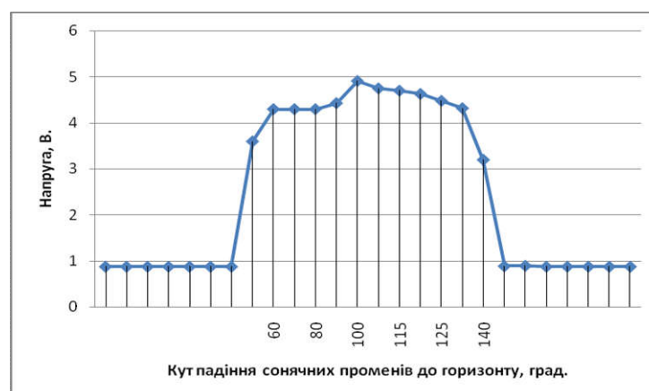
Рис. 10. Залежність напруги, що генерується сонячними панелями, від часу доби при динамічному слідуванні системи керування
