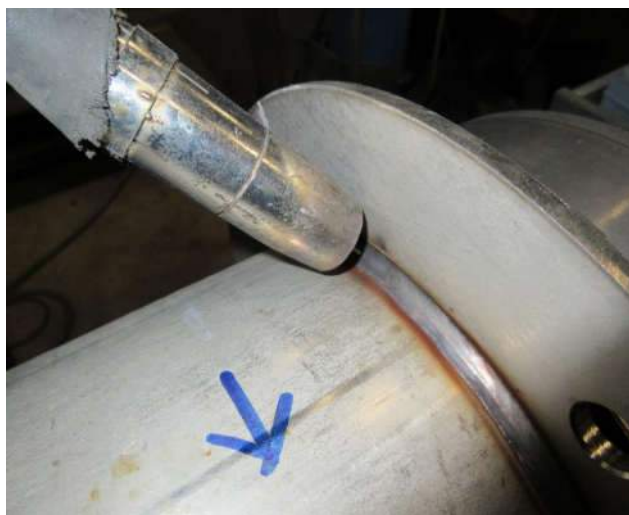
Рисунок 2 - Внешний вид сварного шва, полученного в смеси активных газов
