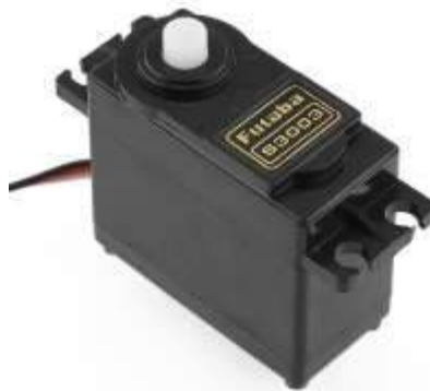
Рис. 5. Сервопривід Wavgat 38 г S3003
