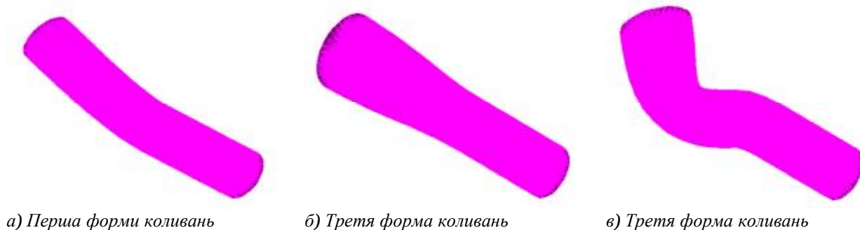
Рис. 2 - Форми коливань деталі-представника
