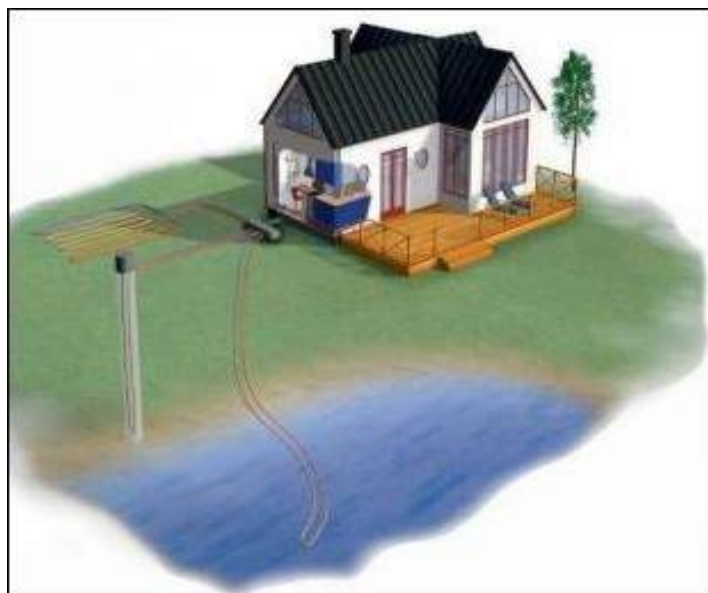
Рис. 1 Джерела відбору геотермального тепла
