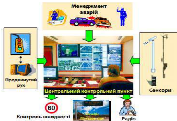
Рисунок 3. – Схема центру регулювання руху та контролю за рухом міського транспорту
