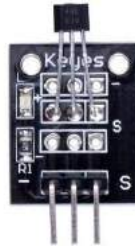
Рис. 3. Датчик Хола Hall KY-003
