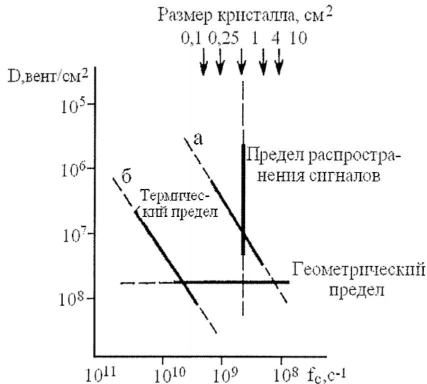
Рис. 1. Диаграмма быстродействие - потребляемая мощность элементов (уровень интеграции СБИС) при наличии трех пределов разработки СБИС (геометрического, термического и распространения сигналов) для двух технологий отвода теплоты с единицы площади кристалла: Q=20 Вт/см 2 (кривая а); Q=1000 Вт/см 2 (кривая б)
