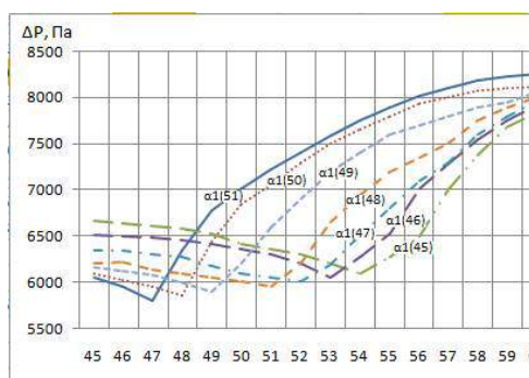
Рис.3 - Потери давления в слое при изменении \alpha_1 (45 \div 51^\circ)
