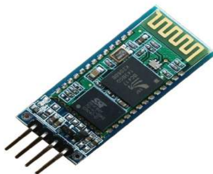
Рис. 3. Bluetooth модуль HC-06
